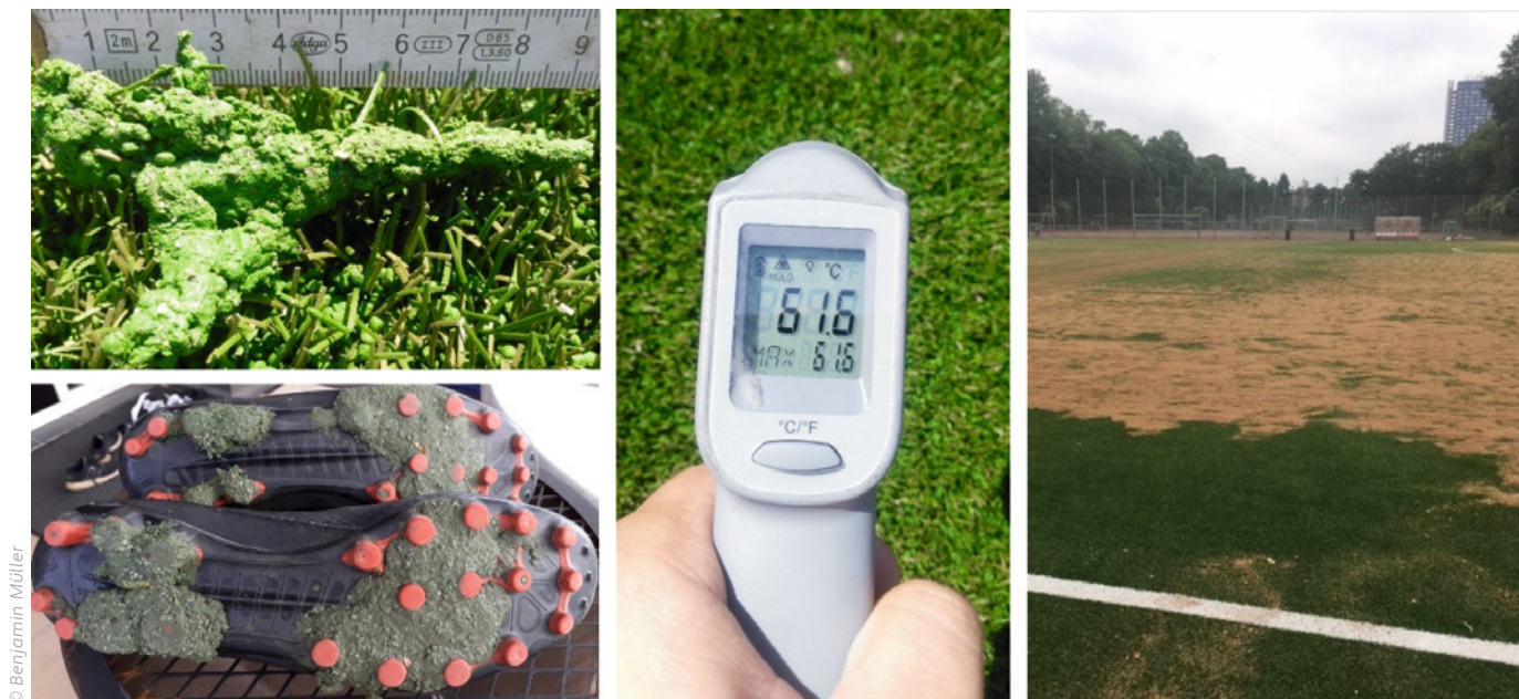
Verklumptes Kunststoffgranulat sowie hohe Oberflächentemperaturen und aufgeschwommenes Korkgranulat nach Wetterextremen auf Sportanlagen im Kölner Stadtgebiet.
